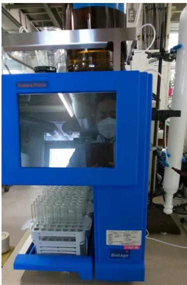
図2. 中圧精製システム
